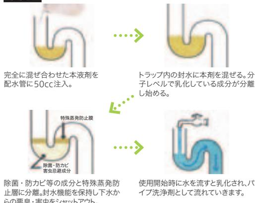
完全に混ぜ合わせた本液剤を配水管に50cc注入。
